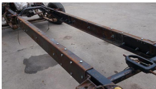
Рис. 4. Удлиненная рама автомобиля ГАЗель NEXT
