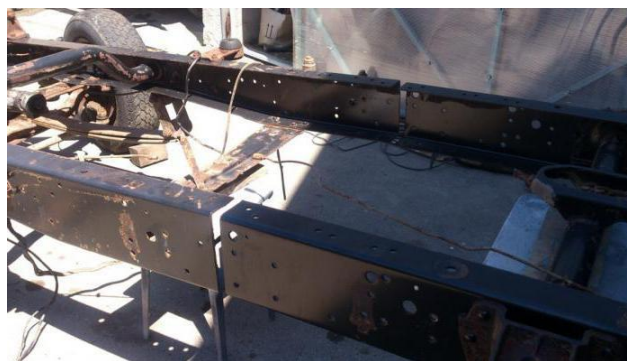
Рис. 3. Места разреза рамы автомобиля ГАЗель NEXT
